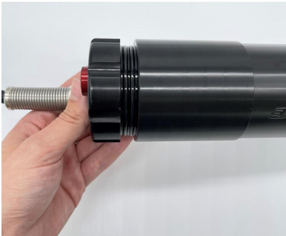
Der Kopf wird im Uhrzeigersinn festgezogen. Die ersten Umdrehungen gehen, wenn er richtig angesetzt ist, sehr leicht. Spürst du einen erhöhten Widerstand überprüfe, ob der Kopf gerade aufgesetzt ist.
