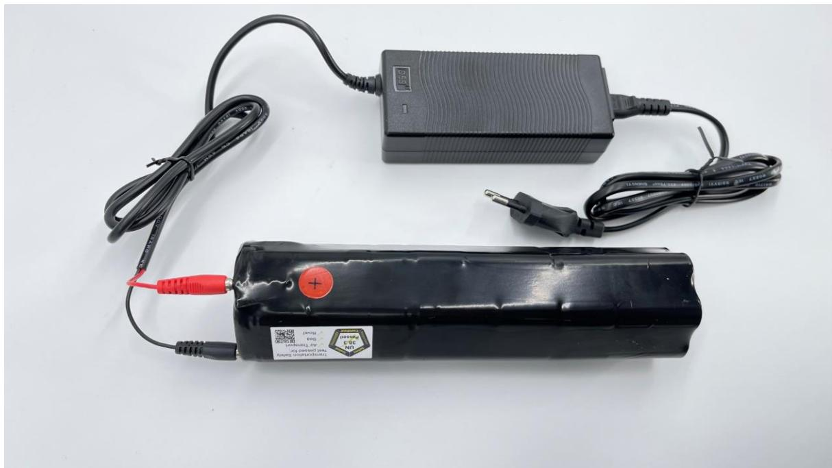
Der Akku hat eine integrierte Elektronik (Balancer). Diese sichert den Akku während des Ladevorgangs und während des eigentlichen Gebrauchs.
