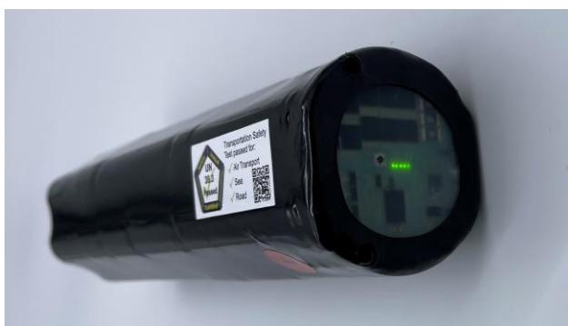
Durch Drücken auf den Punkt, wir die Anzeige aktiviert. Bei der Abbildung links leuchten alle 5 LED's, d.h. der Akku ist vollständig geladen.
